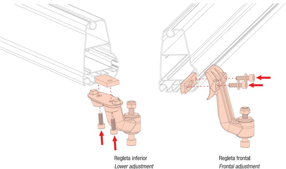
**3** Introducir el taco en la lona, colocar la tapa lateral y atornillar. Introduce the screw-in stud in the textile, place the lateral cap and screw.
